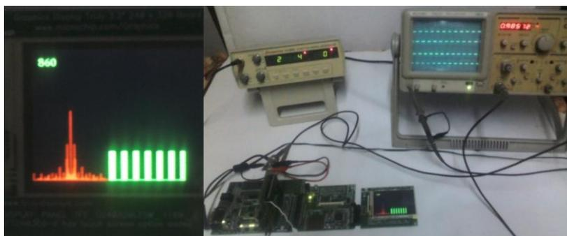
Fig. 11. Señal digital y su representación espectral junto al esquema de trabajo.
