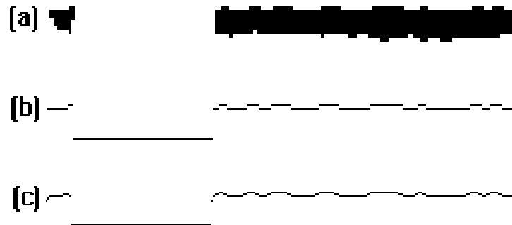
Fig. 16. Resultado de aplicar la esqueletización: a) Imagen Original, b) Esqueletización sin suavizado, c) Esqueletización con suavizado (kernel=5)
