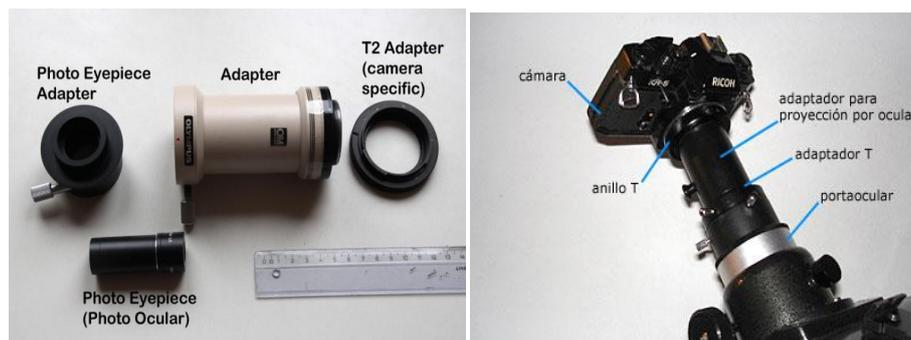
**Fig. 7.** Adaptación de la cámara de fotografía al ocular del biomicroscopio
