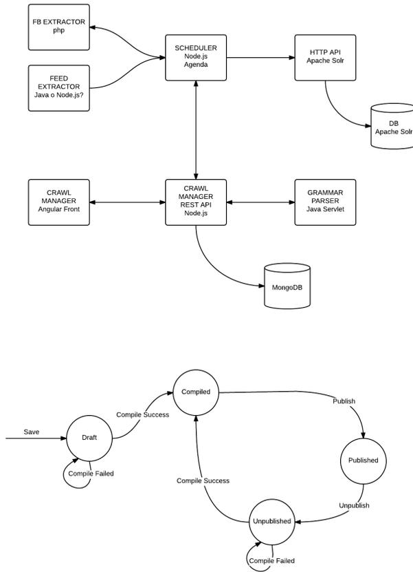
Figura 1. Arquitectura de los componentes de extracción
